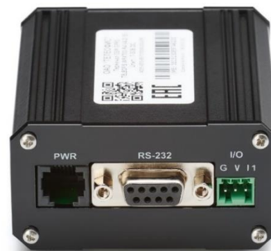
Рис. 5. WRX700-R4/WRX900-R4. Внешний вид со стороны интерфейса.
