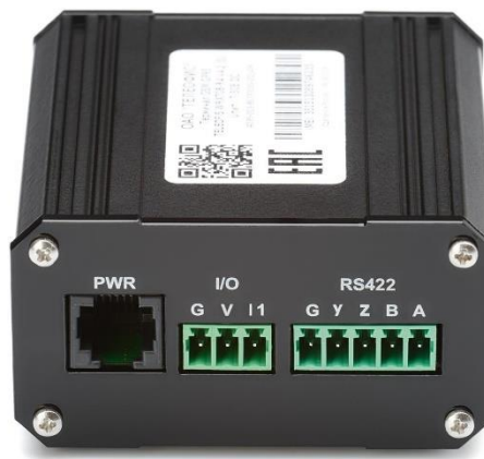
Рис. 9. WRX712-L4, WRX772-L4. Внешний вид со стороны интерфейса.
