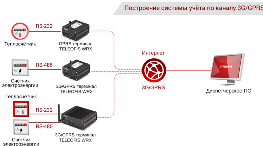
Рис. 2. Построение системы учёта с применением терминалов WRX.
