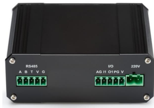
Рис. 8. WRX768-R4/L4, WRX968-R4/L4. Внешний вид со стороны интерфейса.
